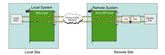
Figure 3-9. Inband Remote CSU Loopback
