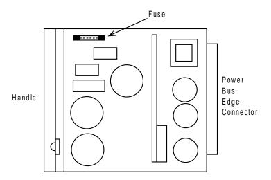
Figure 3-6. -48V Converter Fuse
