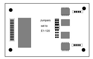
Figure 7-5. DSX/CEPT Module Jumpers (E1 120 Ohm)
