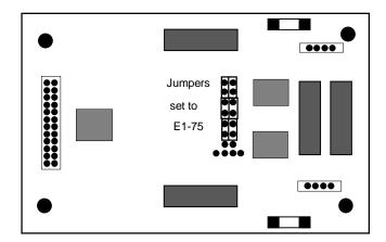
Figure 7-8. DSX/CEPT Module Jumpers (E1 75 Ohm)
