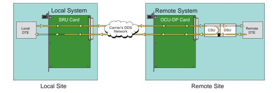
Figure 2-7. Inband Remote CSU Loopback
