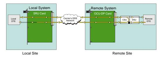
Figure 2-7. Inband Remote CSU Loopback
