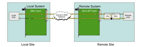
Figure 2-7. Inband Remote CSU Loopback
