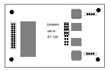
Figure 6-3. DSX/CEPT Module Jumpers (E1 120 Ohm)
