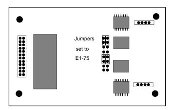
Figure 6-2. DSX/CEPT Module Jumpers (E1 75 Ohm)
