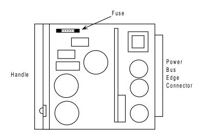
Figure 3-6. -48V Converter Fuse
