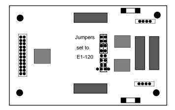
Figure 7-9. DSX/CEPT Module Jumpers (E1 120 Ohms)
