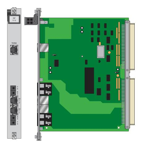
Figure 6-3. INF T1\*2 Interface Card
