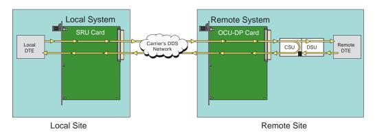
Figure 2-9. Inband Remote CSU Loopback
