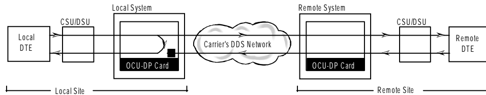
Figure 3-3. OCU Local Loopback (dte option)
